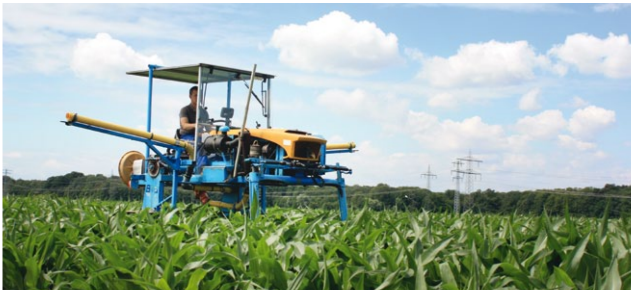
Trichogramma-Ausbringung mit dem Stelzenschlepper
