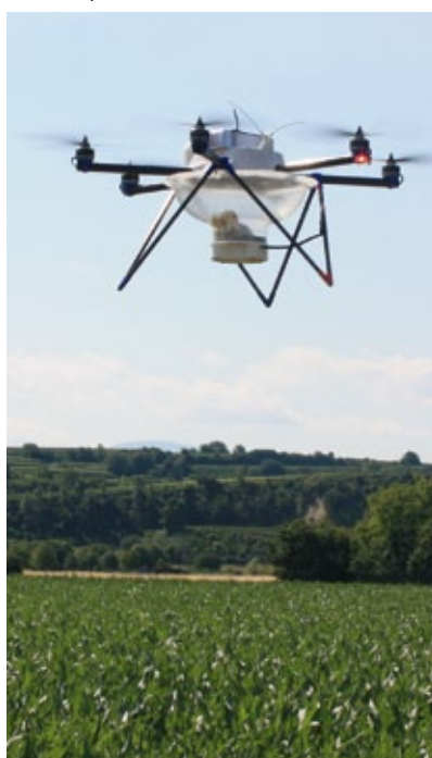
Trichogramma-Ausbringung mit dem Multikopter
